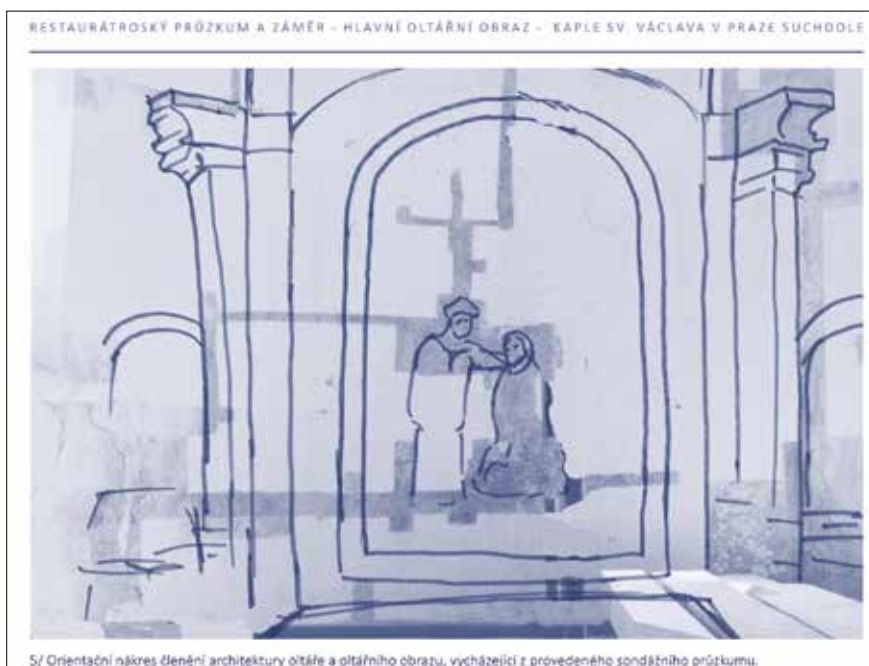
S/ Orientační náčrtek členění architektury oltáře a oltářního obrazu, vycházející z provedeného sondážního průzkumu.
