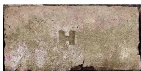
Cihla s kolkem H z cihelny Antonína Hergeta v Sedlci. Velikost 29 x 14 x 7 cm. Nalezeno v ulici Podbabská v Dejvicích. (Zdroj: J. Zavřel-Miloš Komanec, Staletá Praha, 2016/2)
